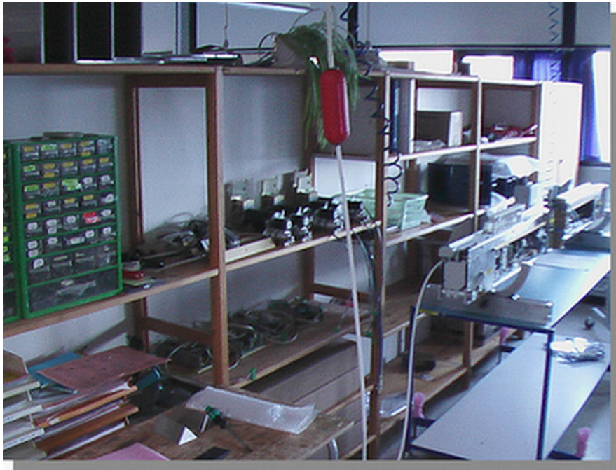
Moduler til slutmontage placeres tilfældigt i et overskud af reolplads
